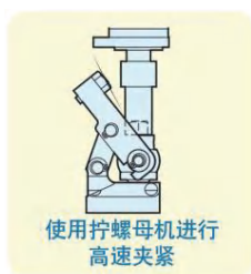
夹杆可弹起, 工件 装卸方便
